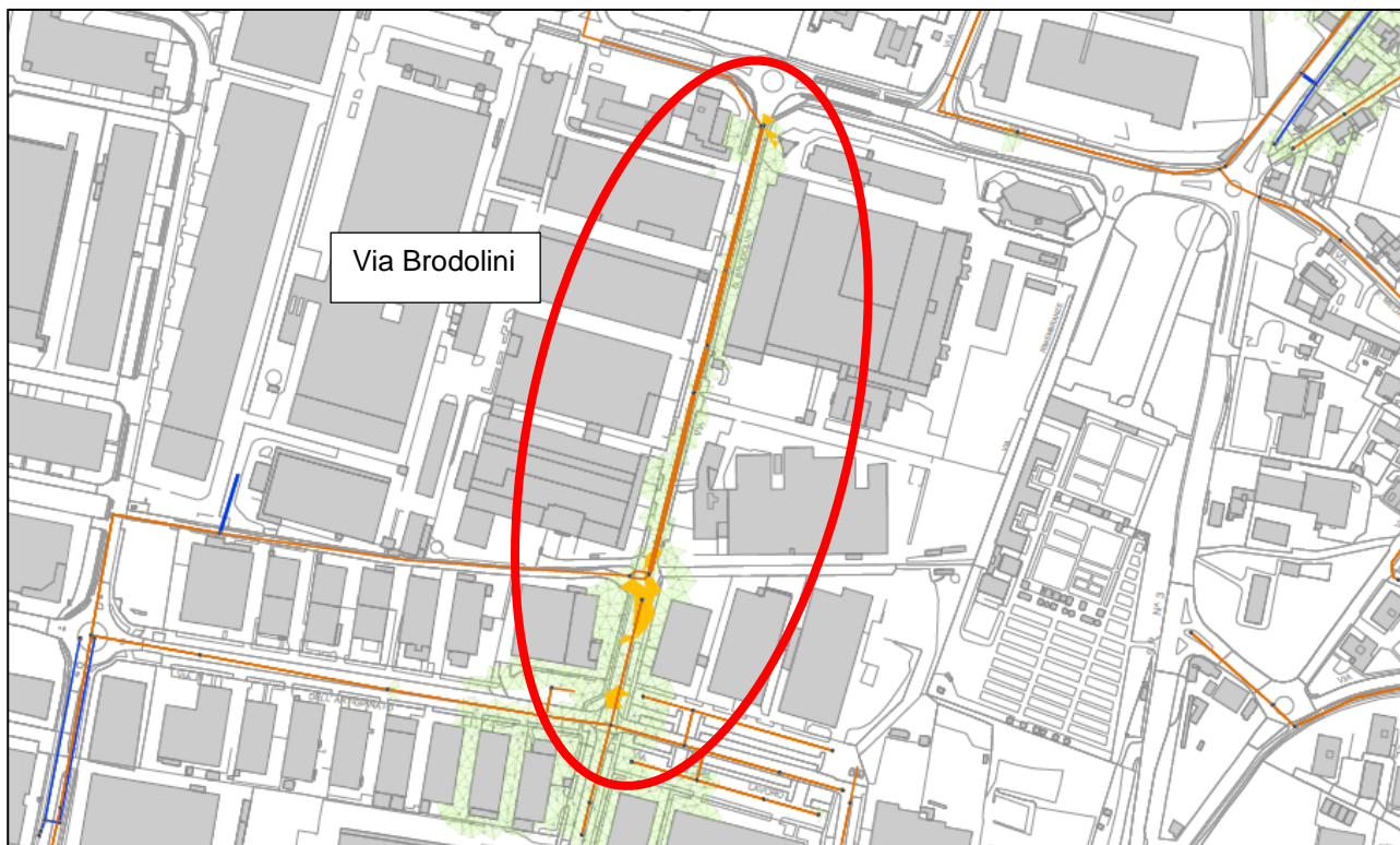
Figura 9: Aree con criticità idraulica dovute alla fognatura T50 in via Brodolini
