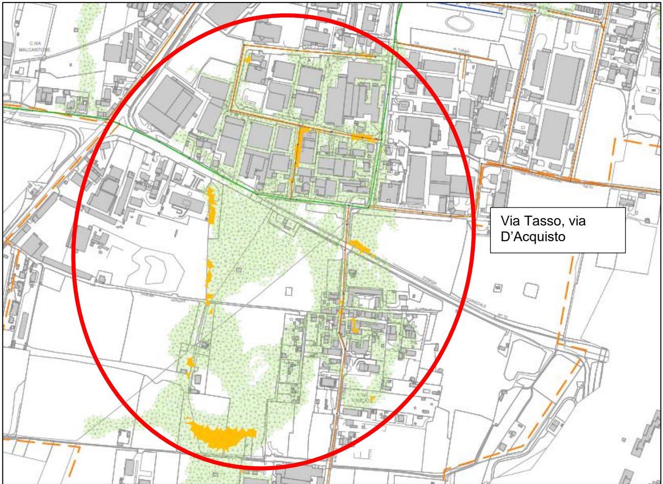
Figura 3: Aree con criticità idraulica dovute alla fognatura T50 in via Tasso, via D'Acquisto
