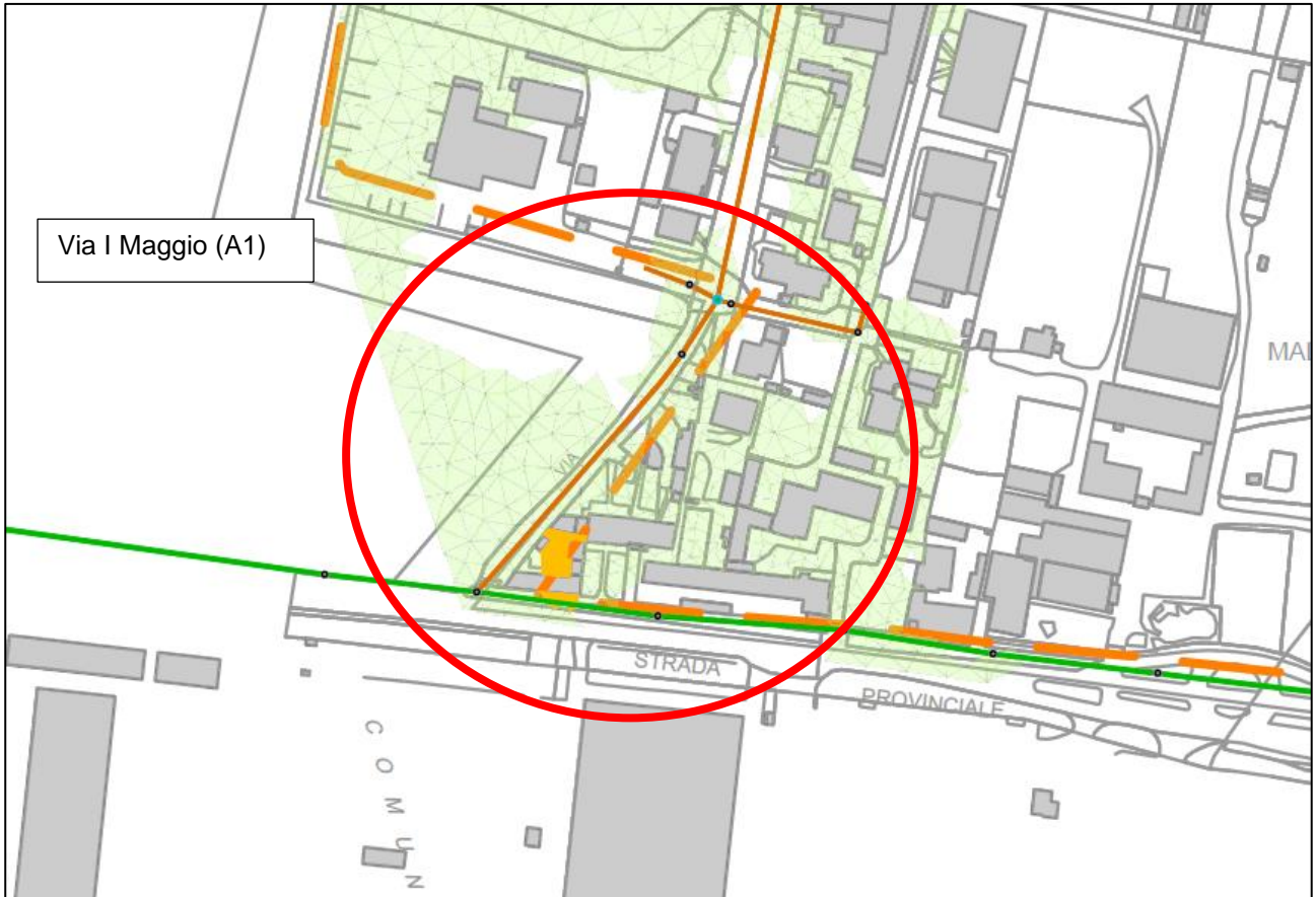
Figura 2: Aree con criticità idraulica dovute alla fognatura T50 in via I Maggio
