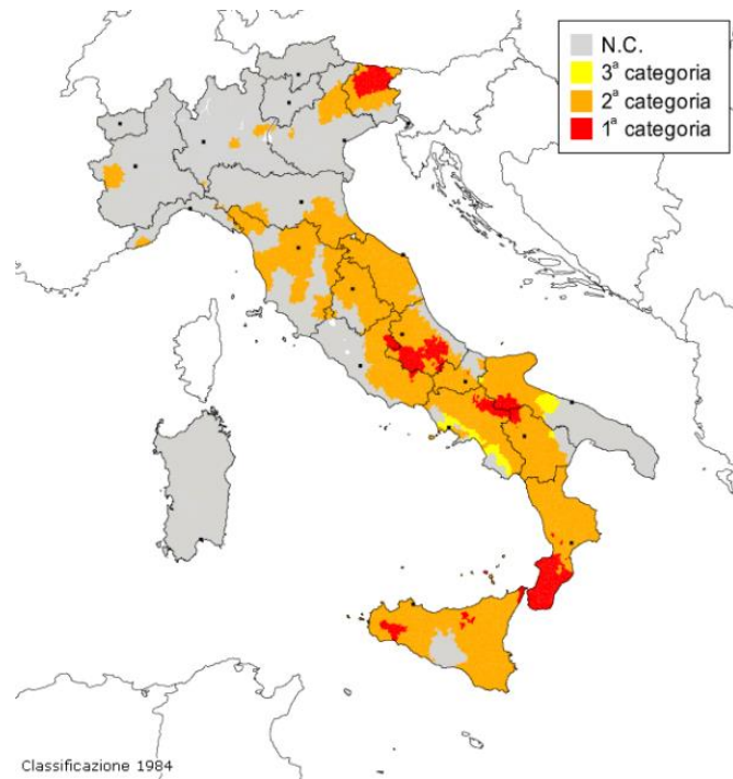
Figura 3 Classificazione sismica del territorio italiano (1984), Decreto del Ministero dei Lavori Pubblici del 14/07/1984 e successive modifiche e integrazioni (fonte: http://zonesismiche.mi.ingv.it/class1984.html ).
