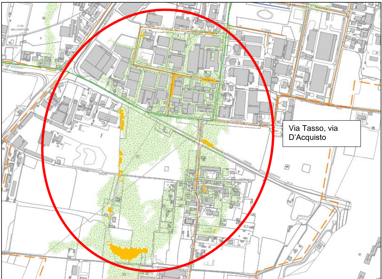
Figura 33: Aree con criticità idraulica dovute alla fognatura T50 in via Tasso, via D'Acquisto
