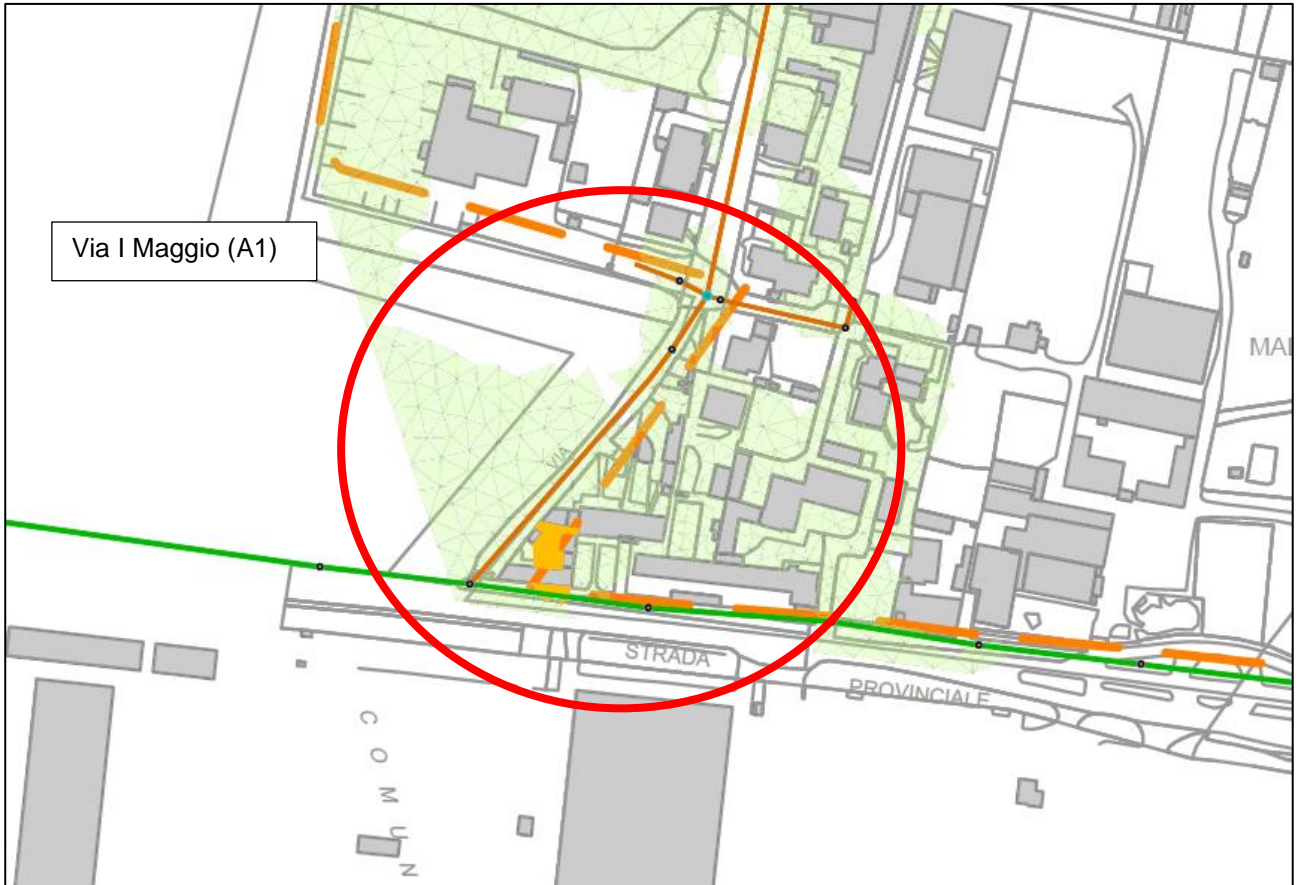
Figura 32: Aree con criticità idraulica dovute alla fognatura T50 in via I Maggio
