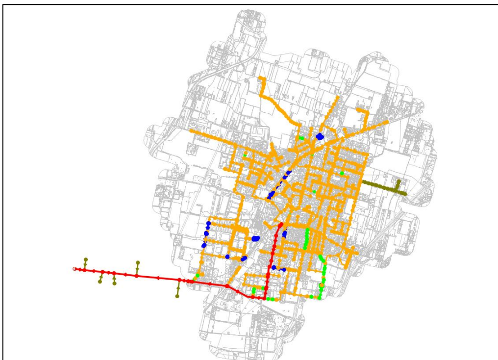
Figura 5: Schema della fognatura del comune di Concorezzo (in rosso il collettore intercomunale)
