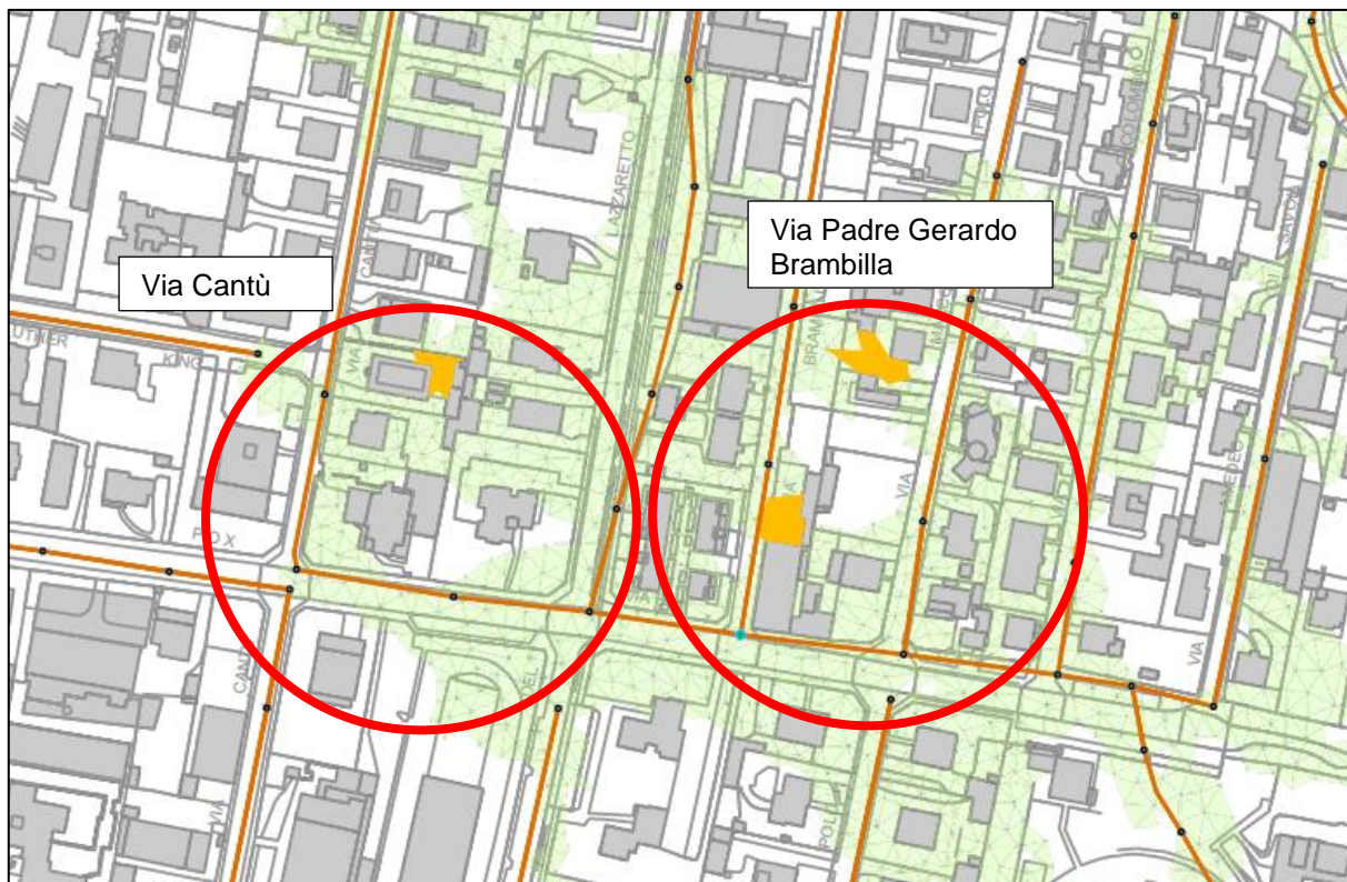
Figura 36: Aree con criticità idraulica dovute alla fognatura T50 in via Cantù e via Padre Gerardo Brambilla
