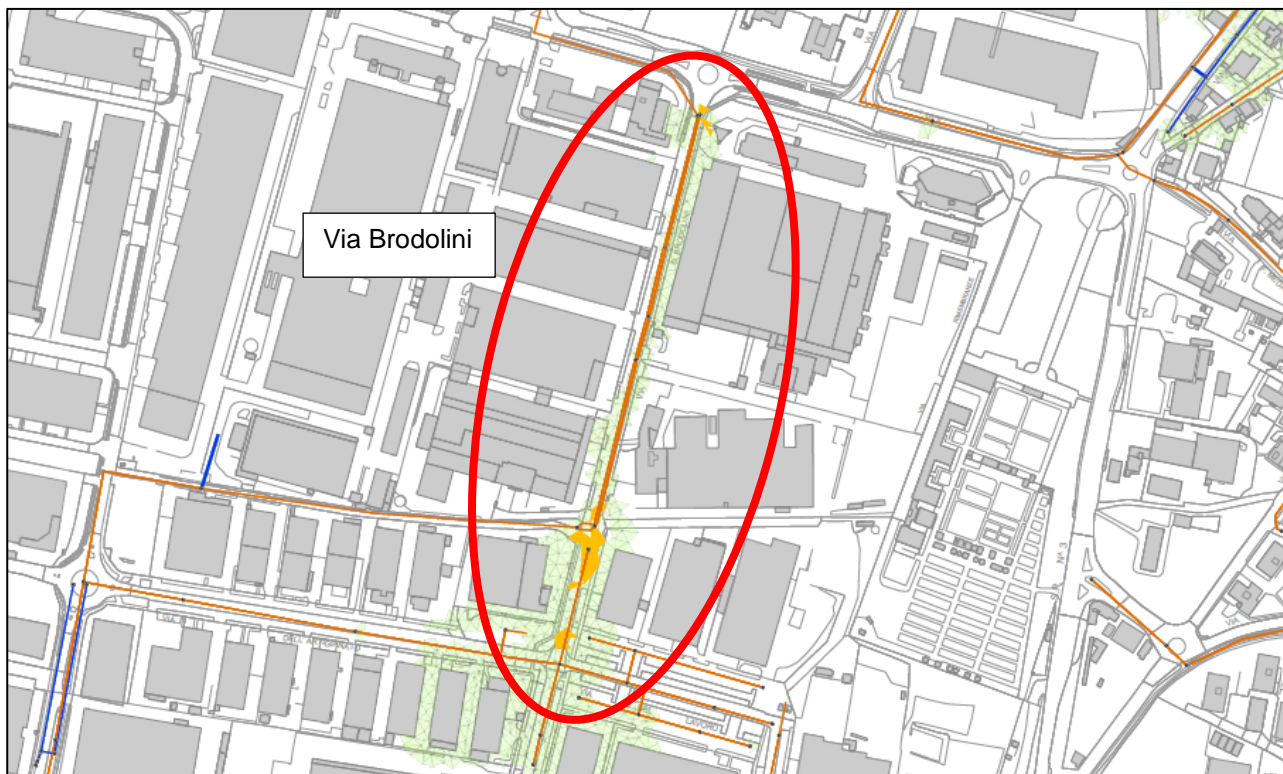
Figura 39: Aree con criticità idraulica dovute alla fognatura T50 in via Brodolini
