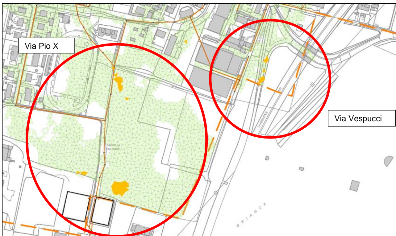
Figura 35: Aree con criticità idraulica dovute alla fognatura T50 in via Pio X e via Vespucci
