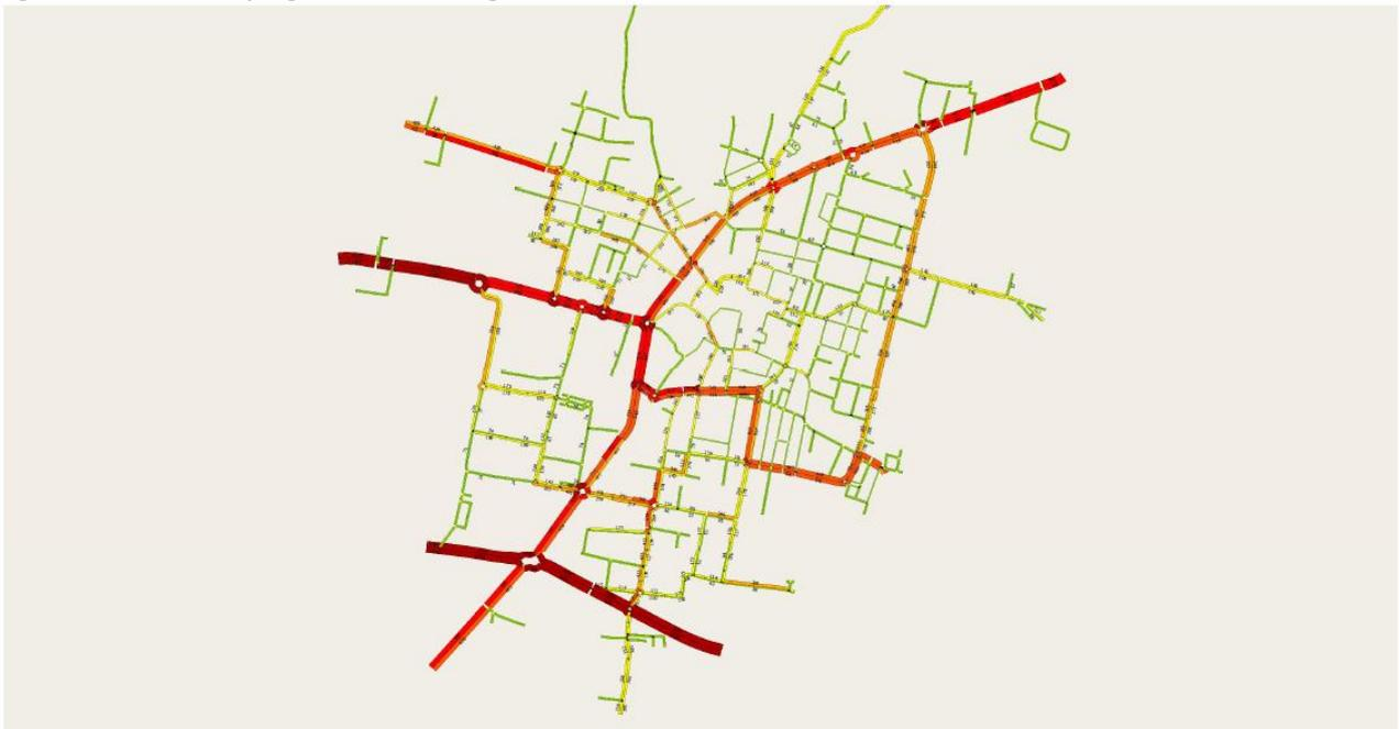
Figura 5-16: Stato di progetto. Flusso/capacità.
